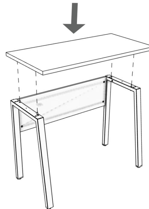
Aplique os tampos e faça a fixação na estrutura metálica.
