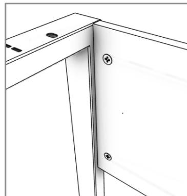
2. - Fixe o Tampo(1), na estrutura, com parafusos(B).
